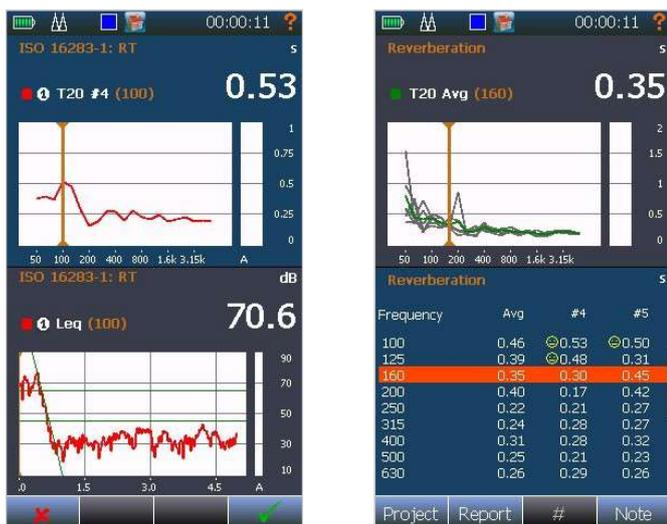
Grafico del decadimento temporale del segnale (a sinistra). Spostandosi con il cursore lungo l'asse della frequenza si visualizza la curva del tempo di riverberazione corrispondente. Premendo il pulsante Num si ottengono i corrispondenti valori numerici. In alternativa, tutte le misurazioni del tempo di riverberazione e i valori medi vengono visualizzati insieme (a destra).
