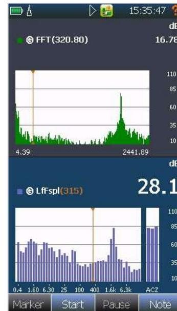
*Doppia vista con FFT e 1/3 di ottava. La funzione del cursore di collegamento collega il cursore in FFT e 1/3 di ottava, facilitando la manovra nel dominio della frequenza*
