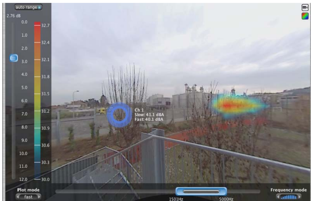
Figura 5 – Vista dello stabilimento industriale dal ricettore scolastico tramite l'Acoustic Camera NORSONIC 848
